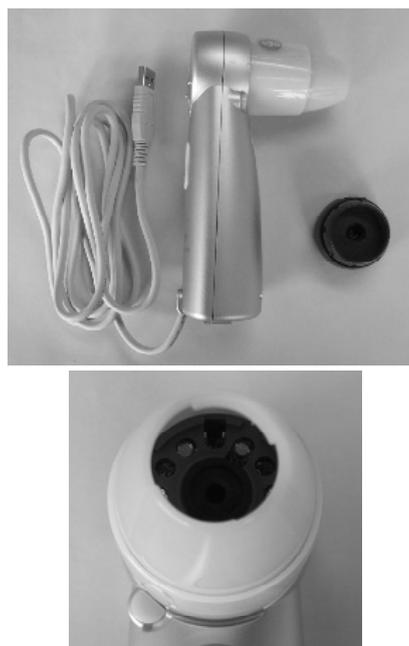
図 1. USB 顕微鏡の外観
