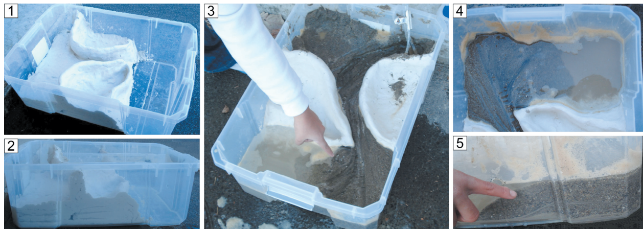
図4. 堆積を強調した流水モデル実験器。1：容器中の油粘土の成型。2：成型した油粘土の断面。3：給水30分後のようす。4：滞水部のようす。5：滞水部の断面。
