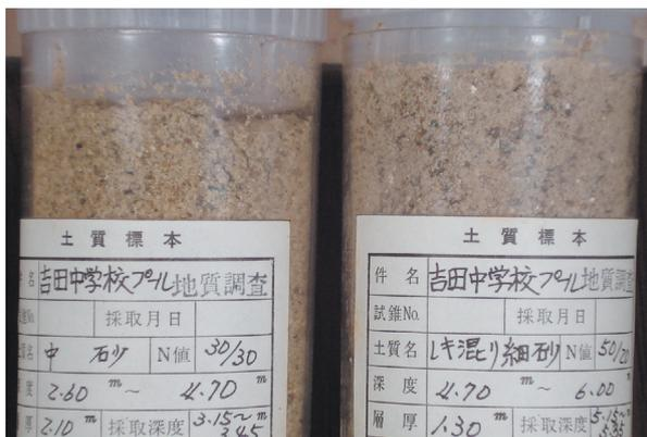
図6. 吉田中学校の地質ボーリング標本の例。陸成層の中粒砂。図5のBを参照。
