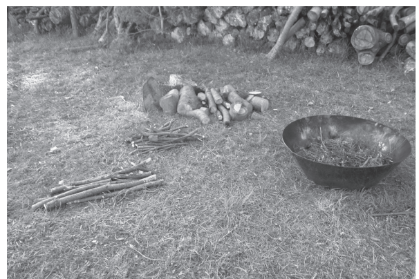
図3. たきつけ用の小枝を敷き詰めた炭化器と太さ別に集めた炭材
