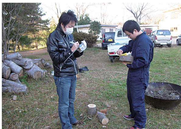
図4. 炭材の直径と長さの測定
