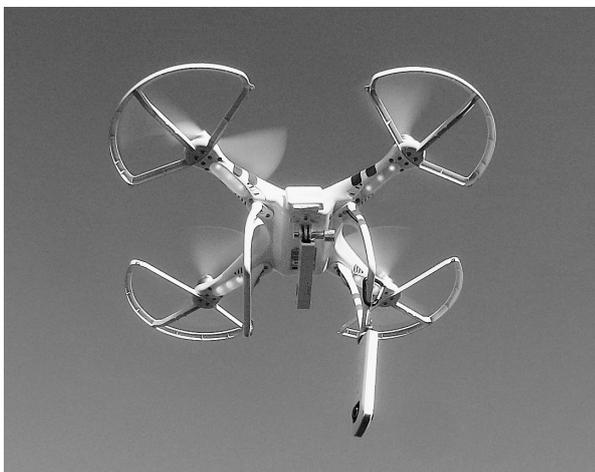
図4. 全天球カメラを取付けたマルチコプター
