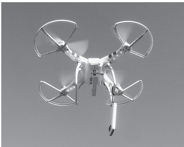
図4. 全天球カメラを取付けたマルチコプター
