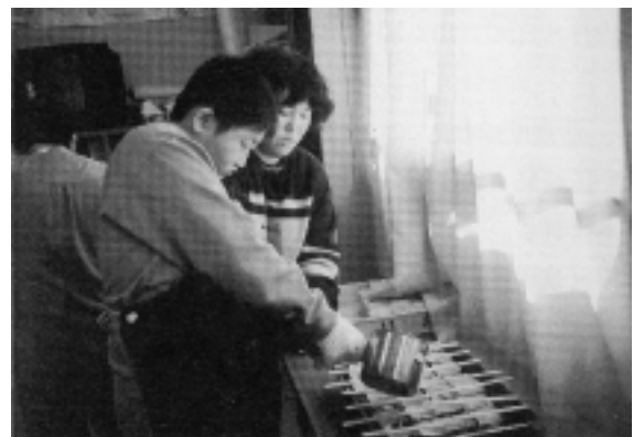
写真4 流し込みをしている様子
