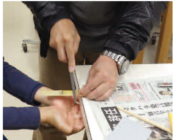
図5 鉄工やすりで刻みを作っている様子
