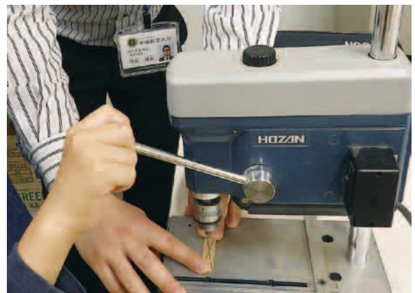
図6 ポール盤でプロペラに穴をあけている様子
