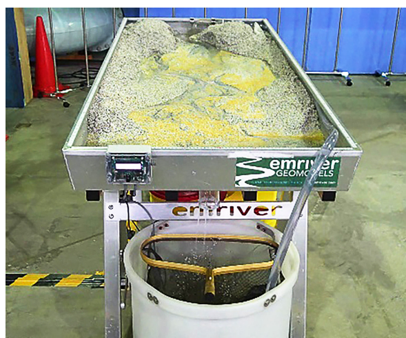
図1. Little River Research & Design社製Emriver Em2 (写真は寒地土木研究所所有の機材)
