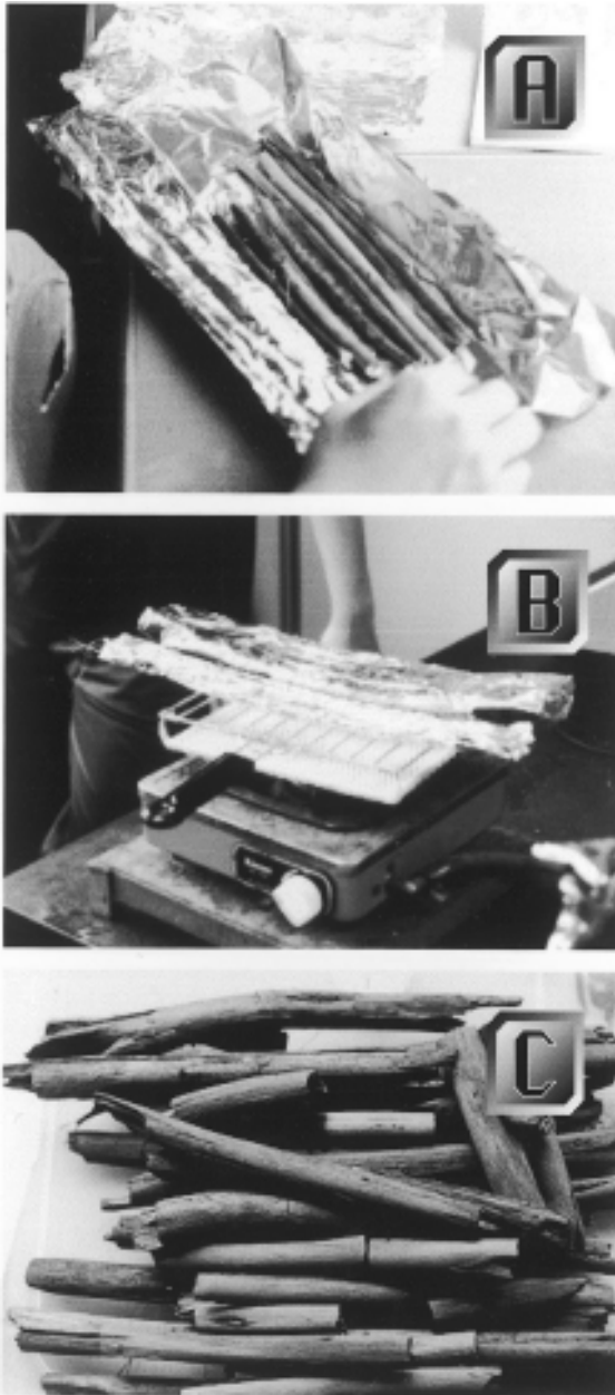
図1 ケナフ木質部を用いた炭焼き A：アルミホイルで木質部を包む B：魚焼き網にのせ、コンロで焼く C：木質部で作った炭
