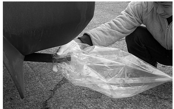
図 12. 自動車排気ガスの二酸化炭素を集気しているようす
