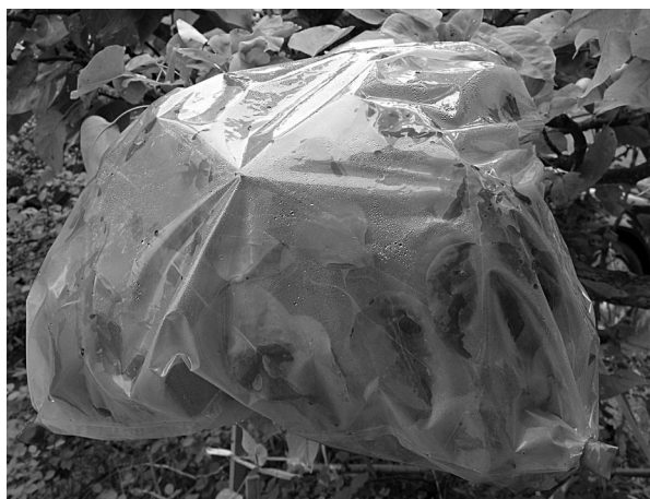
図 9 樹木の光合成による二酸化炭素の吸収を調べているようす。
