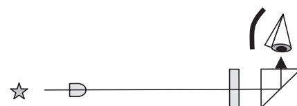
図2. 夜空メーターの光学系 左より夜空、発光ダイオード、フィルター、天頂プリズム、目。
